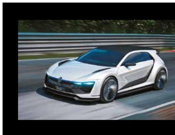
**Volkswagen Golf GTE Sport** — A carroceria deste conceito é desenvolvida totalmente em fibra de carbono. O carro, de tração integral, alia o motor quatro cilindros 1.6 TSI de 299 cavalos a dois propulsores elétricos, que geram mais 115 cavalos, combinados. O resultado: 414 cavalos, 68,3 kgfm de torque, aceleração de 0 a 100km/h em 4,3 segundos e velocidade máxima de 280km/h. A autonomia, utilizando somente o modo elétrico, é de até 50 quilômetros.
